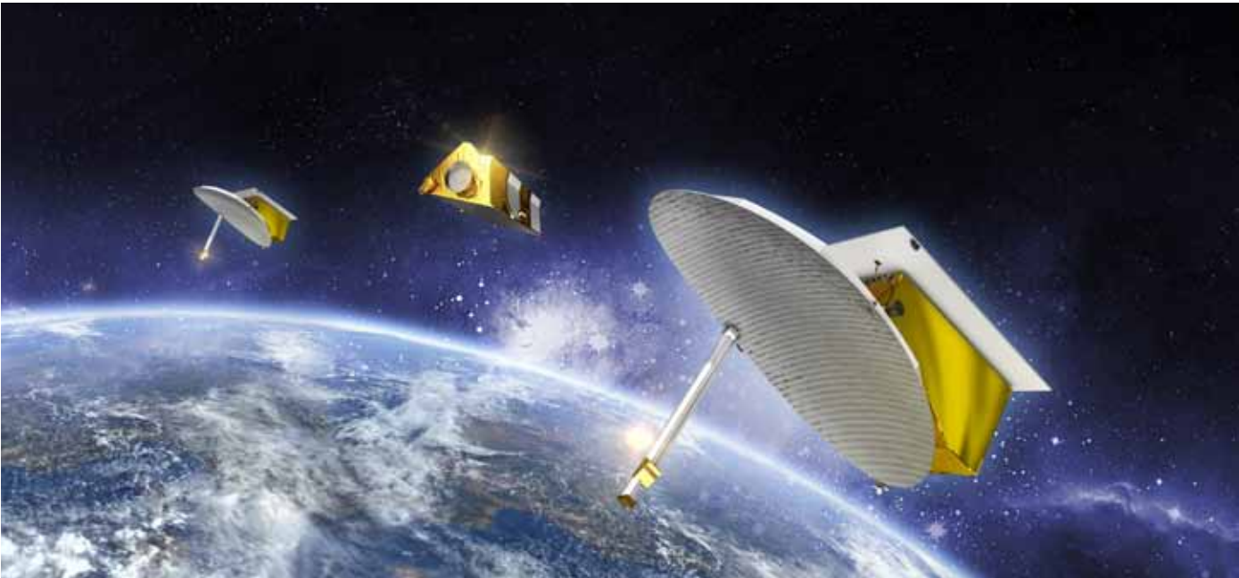
Das künftige Radaraufklärungssystem SARah umfasst drei Satelliten und zwei Bodenstationen. Bilder auf der rechten Seite: Die derzeitige Konstellation SAR-Lupe arbeitet seit 2007 erfolgreich mit fünf identischen Satelliten und einem entsprechenden Bodensegment in Gelsdorf. The future radar reconnaissance system SARah comprises three satellites and two ground stations. Pictures on the right-hand side: The present constellation SAR-Lupe is operational since 2007 and includes five identical satellites and a corresponding ground segment in Gelsdorf, Germany.
