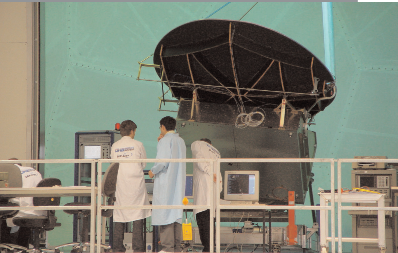
SAR-Lupe Engineering Modell beim SAR-End-to-End-Test.
