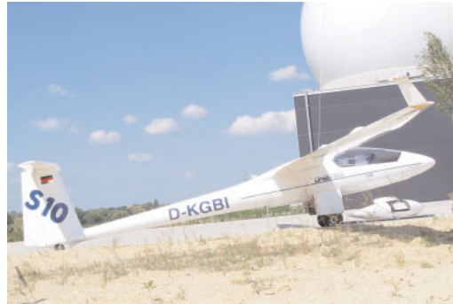
Der Motorsegler Stemme S 10 dient als Erprobungsträger für die Entwicklung von bemannten/unbemannten Drohnen (CONDOR).
