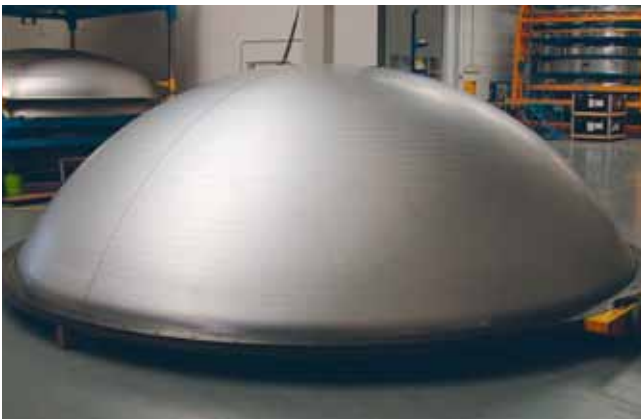
Trennwand für Tanks der Oberstufen von Trägerraketen der nächsten Generation
