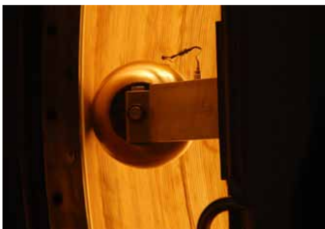
Tankdome während des Rührreibschweißens bei MT Aerospace in Augsburg
