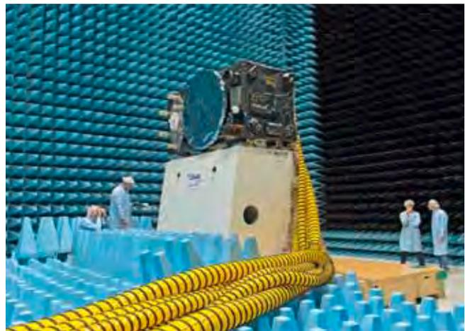
Galileo\* FOC FM1 bei der Vorbereitung für den PIM-Test
