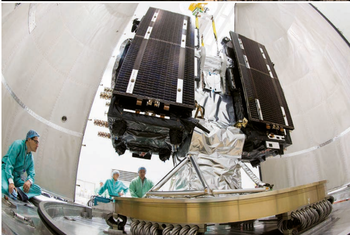
Galileo*-Start am 27. März/Galileo-FOC*-Satelliten auf dem Dispenser kurz vor dem Start
