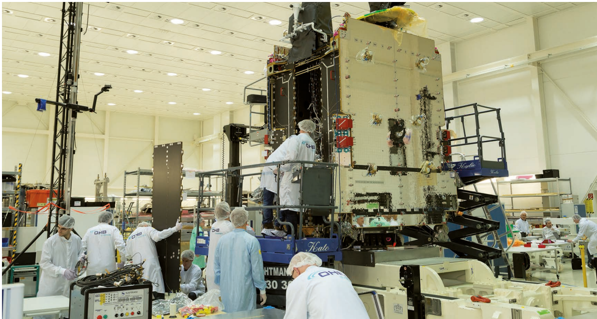
„Hispasat Advanced Generation 1“ fertig integriert im OHB-Reinraum
