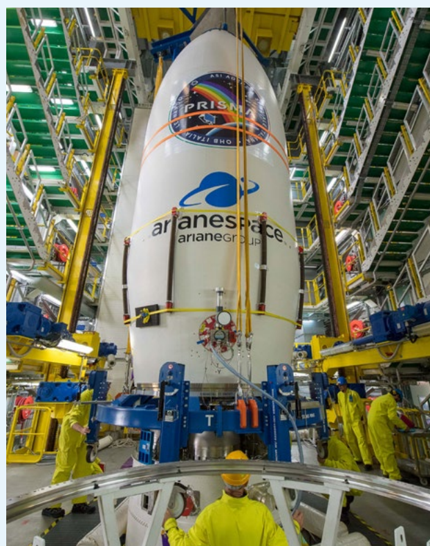
Koppelung der Nutzlastverkleidung um den Satelliten
