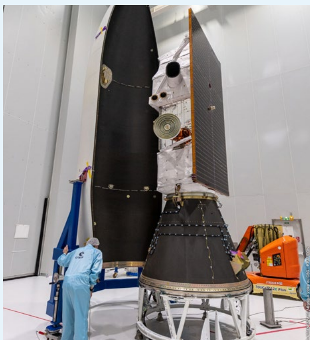
Einkapselung des Satelliten in die Nutzlastverkleidung
